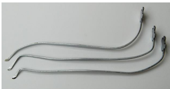
ابزار حمل کننده ساند پُست جهت جاگیری در داخل ویلن
